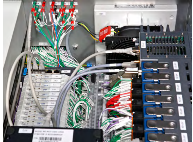
Ein vorgefertigter Kabelbaum erleichtert die interne Verkabelung.
